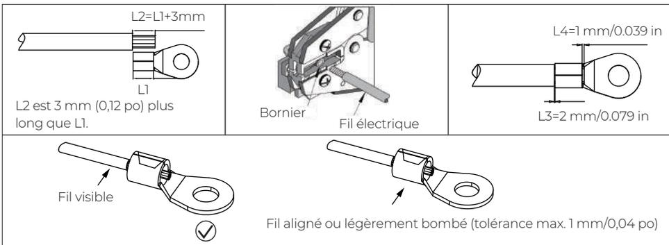
**Étape 3:** Fixez la borne OT à l'aide d'une vis M5 à l'endroit indiqué dans la figure ci-dessous. Mettez solidement à la terre l'autre extrémité du câble de la manière préférée.
