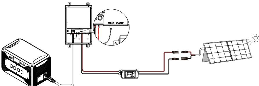
**Remarque :** lorsque vous utilisez des blocs-batteries BLUETTI, assurez-vous que le câble Ethernet est connecté correctement au port de communication CAN.
